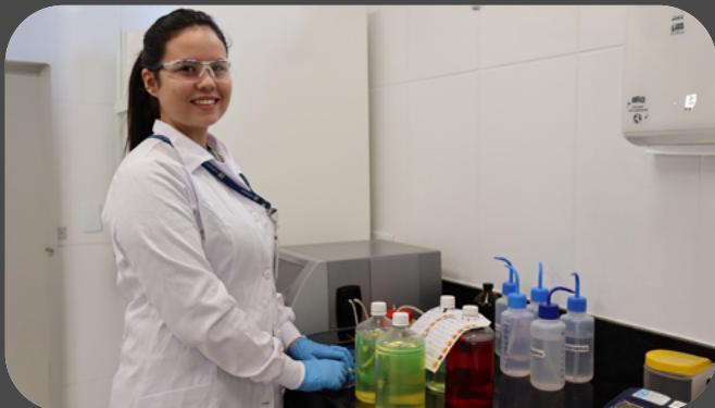
**LABORATÓRIO:** local onde são realizadas análises para a garantia das propriedades dos granéis líquidos movimentados. As amostras coletadas passam por verificações como: condutividade, densidade, acidez e umidade.
