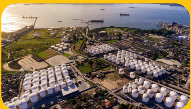
**CENTRO DE TANCAGEM:** recintos onde são construídos diversos recipientes estáticos de alta resistência, chamados de tanques, onde são armazenados líquidos que podem ser utilizados em diversos processos da indústria. A Cattalini Terminais possui quatro Centros de Tancagens, alfandegados e entrepostados, com capacidade estática total de 610 mil m<sup>3</sup>.
